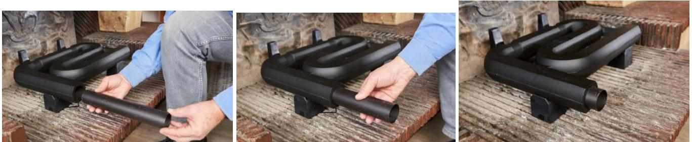
La rallonge de sortie d'air chaud cd 0136-07 doit pouvoir rentrer de 15 à 18 cm environ à l'intérieur du serpentin.
