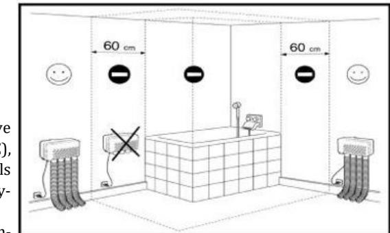
**D - Elektrischer Schuhtrockner :** Bei der Installation muss beachtet werden, dass der Netzschalter nicht von einer Person angefasst werden kann, die sich in der Dusche oder in der Badewanne befindet.
